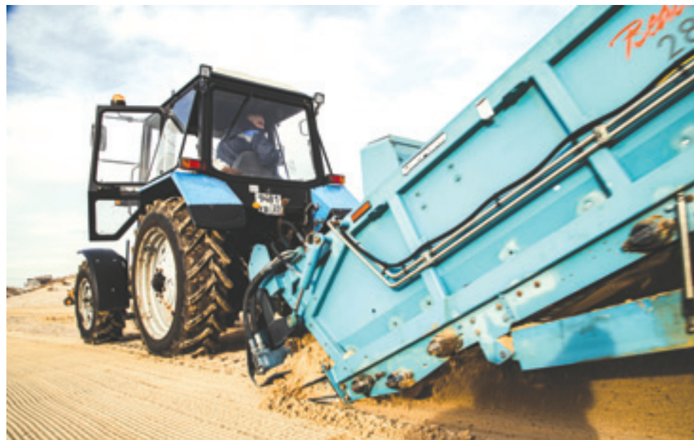
📷 Трактор с просеивающей песком установкой собирает сгустки мазута аккуратнее, чем люди с лопатой.
